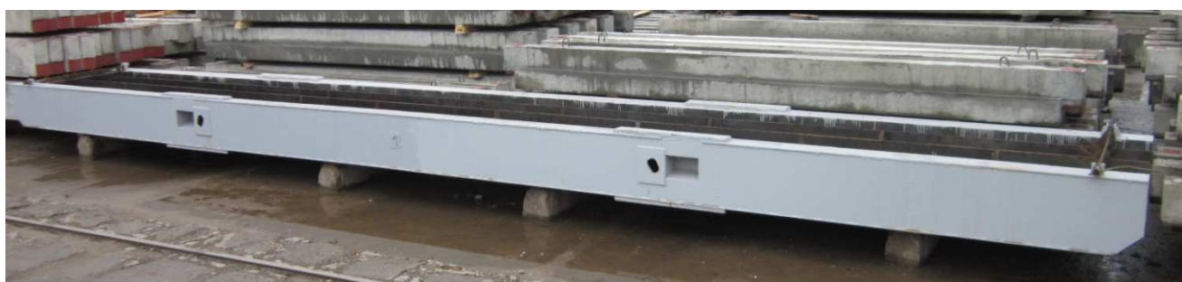
Форма для изготовления свай 350x350x15000мм.
